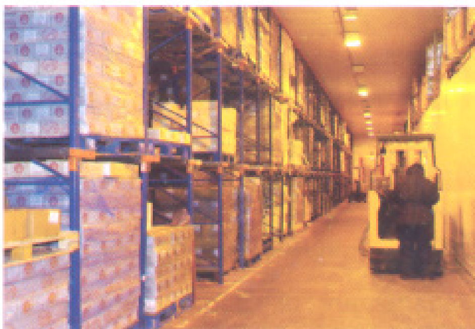
Fig. 33: Un exemplu de bună organizare a depozitării în spațiile de congelare a produsului final prin punerea pe raft, ceea ce previne distrugerea produsului și permite controlul eficient al stocurilor, având un iluminat corespunzător.
