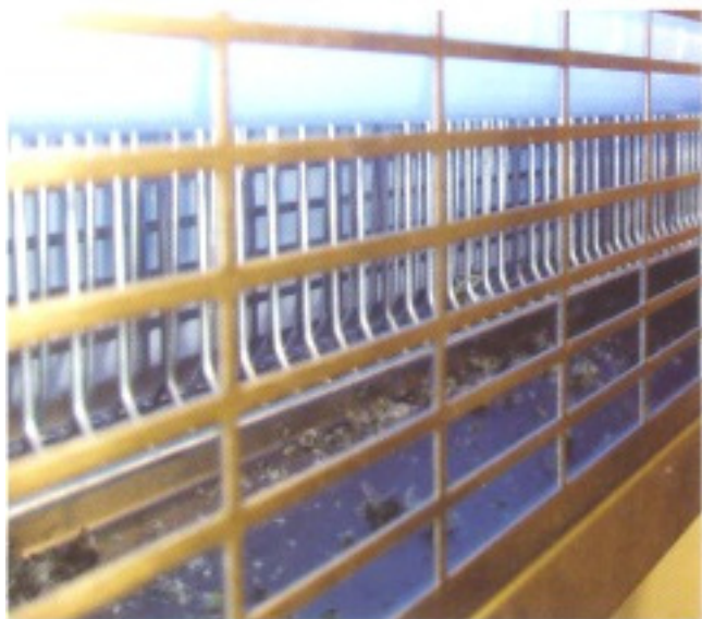
Fig. 31: Închiderea unei capcane de insecte, care necesită o inspecție regulată și curățare corespunzătoare.
