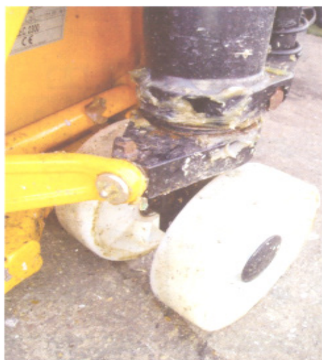
Fig. 22: Echipamentele cum sunt paleții camioanelor care sunt folosiți în mai multe zone de producție pot determina contaminarea în jurul unității.
