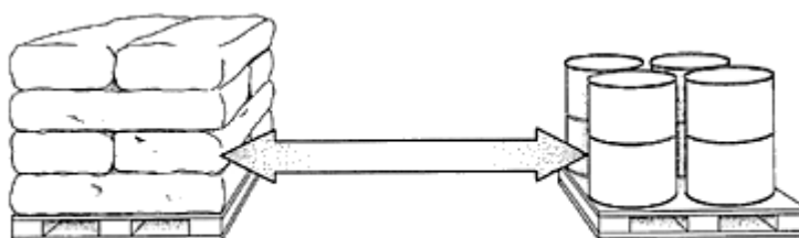
FIGURA 13 – Trecere între pesticide stivuite pentru a permite circuitul liber al aerului și inspecția.
