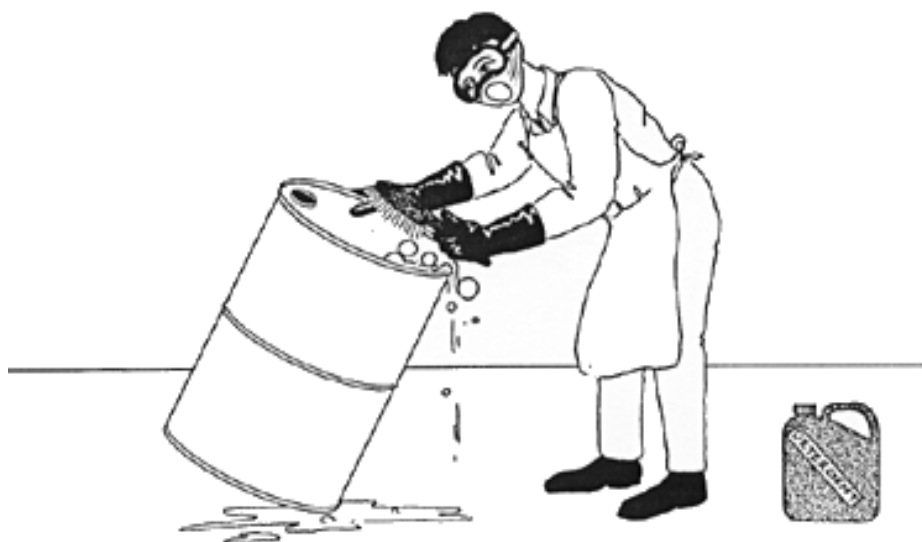
FIGURA 20 - Decontaminarea unui container de pesticide - interiorul și în exteriorul sunt curățate cu detergent și apă. Apa provenită din clătire, puternic contaminată, trebuie să fie canalizată în fosă/scurgere, (separat de fluxul central al apei menajere) pentru eliminare împreună cu alte deșeuri toxice majore
