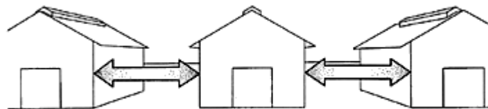
FIGURA 4 - Depozitul de pesticide trebuie să aibă trei laturi libere, pentru a permite accesul echipamentului de combatere a incendiilor în caz de urgență.
