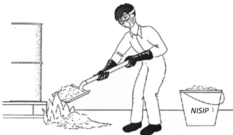
FIGURA 24 - Stingerea unui incendiu mic într-un depozit de pesticide folosind nisip sau pământ uscat
