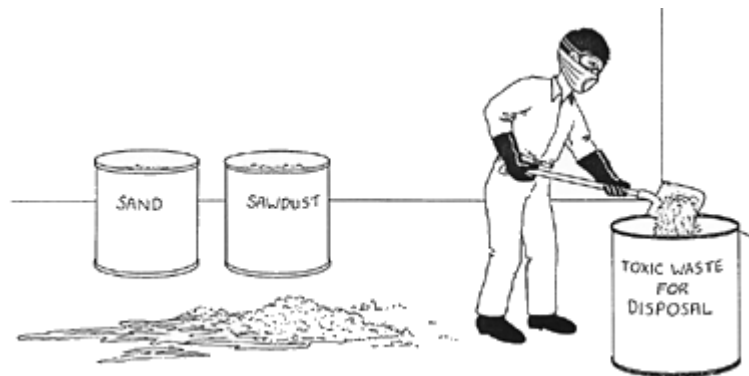
FIGURA 18 – Scurgere de pesticide absorbită cu nisip sau rumeguș, care ulterior este măturat de magaziner și plasat într-un recipient special.
