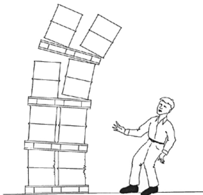
FIGURA 15 – Pesticidele stivuite la înălțimi excesive devin instabile și pot cauza accidente.
